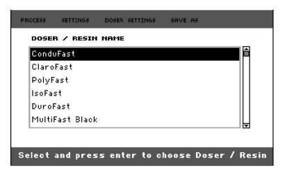
2. Drehen Sie den Knopf, um das Einbettmittel zu markieren, dass der CitoDoser zugeordnet werden soll.
